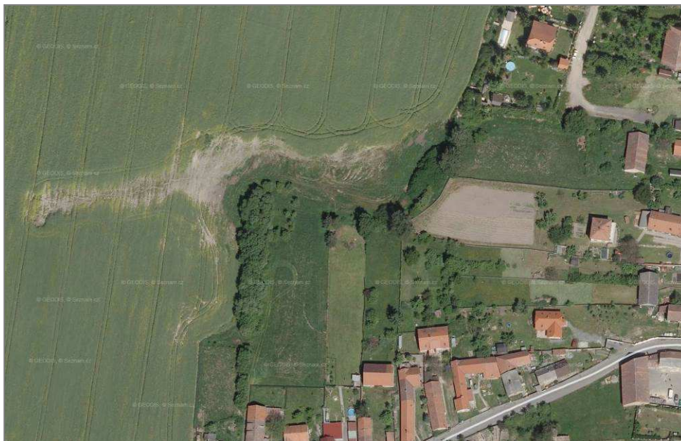
OBRÁZEK 10 PŘÍKLAD NÁSLEDKŮ PŮSOBENÍ SOUSTŘEDĚNÉHO ODTOKU A RÝHOVÉ EROZE NA ZÁPAD OD ROSOVIC (ZDROJ GEODIS)
